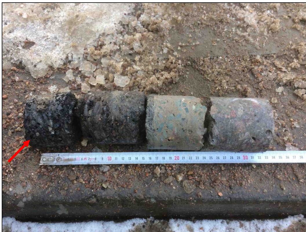
Foto 1: Pohled na výnos z vrtu V5 pro stanovení skladby vozovky. Šipkou vyznačen horní líc vozovky.
